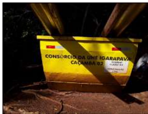
Figura 6.3 - Caçamba utilizada para disposição dos resíduos de construção civil.
